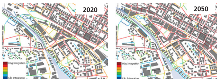
Figur 2 Gångnätets integration år 2020 (till vänster) och år 2050 (till höger) med järnvägen i tunnel och ny bro över Bällstaån
